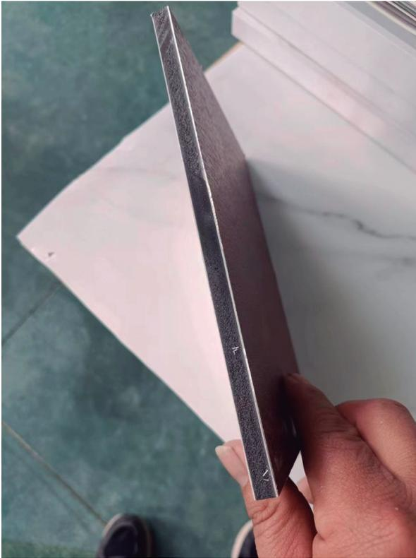
Estos delgados paneles laminados, están formados por piedra natural de mármol o granito en espesores de 3-6mm y cortados con equipo de la más alta tecnología. Los paneles pueden estar compuestos por cualquiera de estas piedras y adheridos a láminas de aluminio, compuestos con estructura honeycomb.
